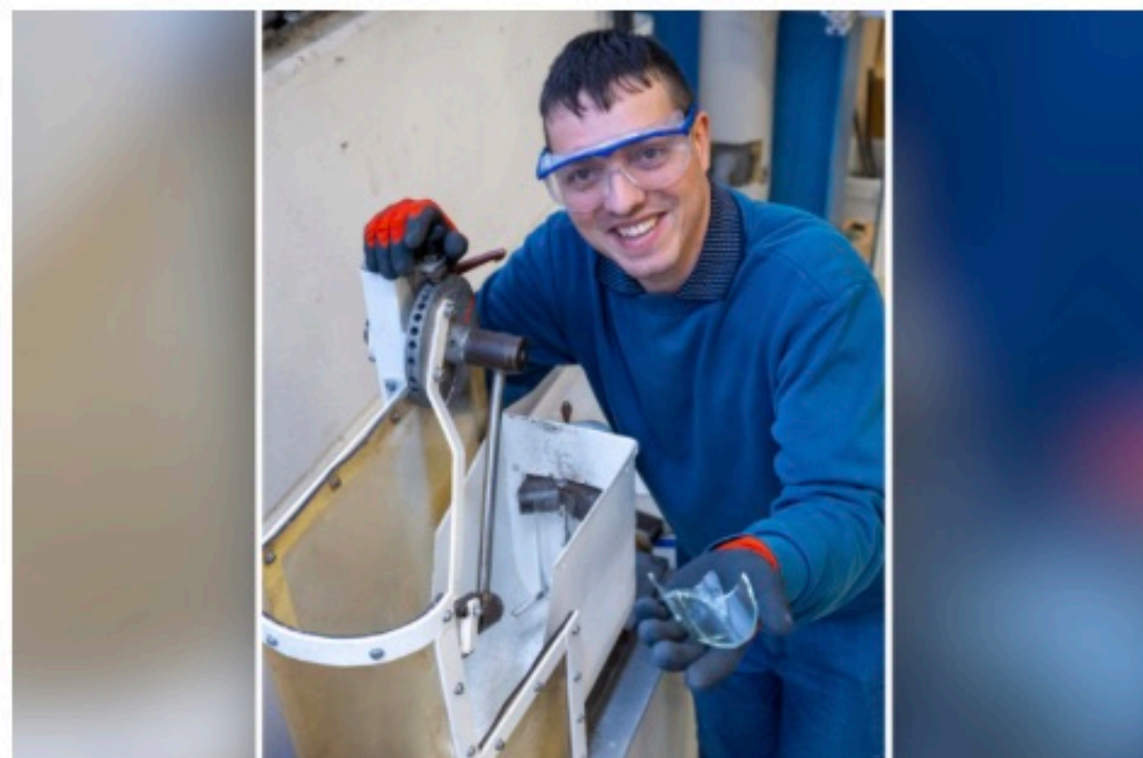
An der Anlage für Pendelschlagversuche testet Martin Groß (38), bei welcher Wucht das Glas zerspringt. © Detlev Müller
