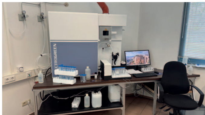
Analysegerät ICP, mit dem Analysen u.a. an Glas und Salzschnmelzen durchgeführt werden. © ReViSalt GmbH
