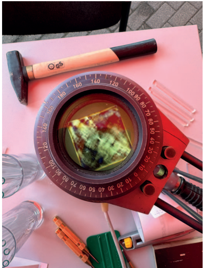
Getempertes Glas (links); mit einem Polariskop können Spannungen im Glas sichtbar gemacht werden. © ReViSalt GmbH
