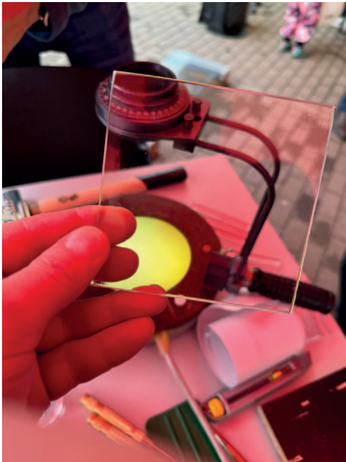
Getempertes Glas (links); mit einem Polariskop können Spannungen im Glas sichtbar gemacht werden. © ReViSalt GmbH
